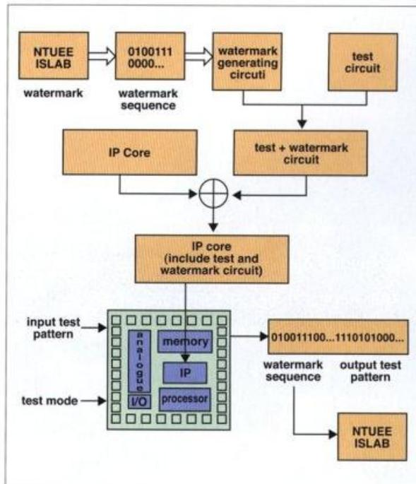
트스트림으로 표현한 것은 '0100111000 ...' 이다. 비트스트림을 발생하는 회로와 의도하는 테스트 회로를 혼합하여 IP 설계에 반영하는 과정은 IP 저작자가 행하게 된다. 이 IP를 IC 설계에 사용하고 테스트 모드에서 동작 시키게 되면 테스트 패턴에 앞서 '0100111000 ...' 과 같은 워터마크가 발생하게 된다. 비트스트림을 20 비트로 설계한다면 220 정도의 IP를 분류하는 것이 가능할 것이며, RTL 수준에서 설계가 이루어 질 수 있으므로 논리합성이나 레이아웃 과정을 거친다고 하더라도 워터마크 발생기능이 변화되지 않는 장점이 있다.
