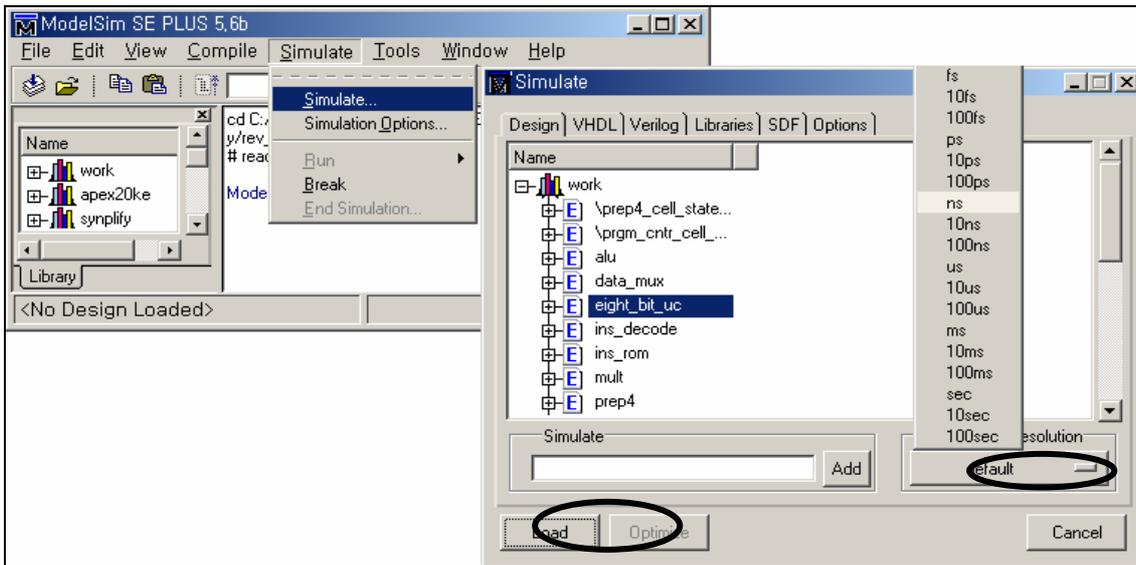
Load에서도 아무런 문제가 없다면 이제는 **Simulation**을 진행하면서 결과를 분석하고 확인해야 할 차례이다. 결과를 확인하는 방법에 따라서 자신이 원하는 방법을 선택하면 된다. **Waveform**을 통해서 확인, 분석한다면 "View" Menu에서 "Wave"를 선택하고, **Table** 형태로 보고 싶다면 "List"를 선택해서 확인하면 된다. 원활한 확인과 분석작업을 위해서 제공하는 모든 기능들을 보고 싶다면 "All windows"를 선택하면 모두 볼 수 있다. 그러나 너무 많은 **Window**들을 보고 있으면 혼란스러울 수 있으므로 최소한의 **window**를 이용하는 것이 여러 가지 측면에서 좋다.
